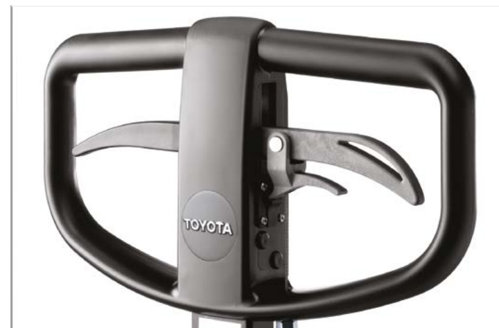
Esta alavancagem é acionada pela alavanca de controlo manual na pega do timão
