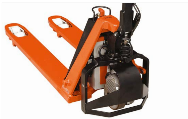
O motor e a bateria do LHT100 são compactos o suficiente para que este porta-paletes manual seja tão manobrável quanto um BT Lifter standard.
