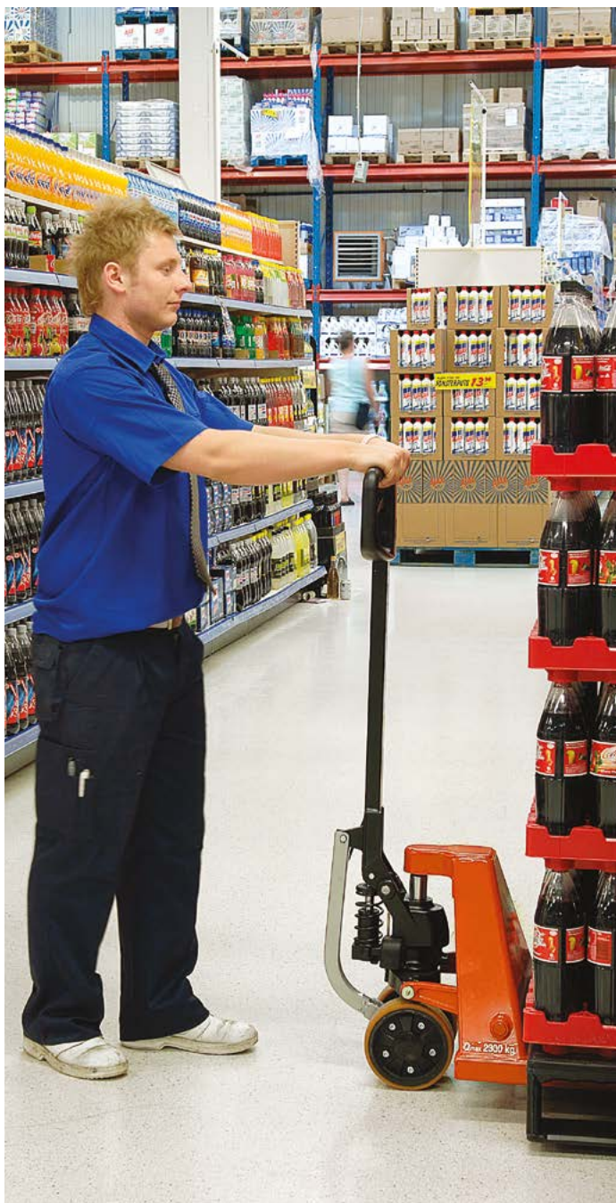
O braço de direção do LHM230P assegura alavancagem nas rodas para ajudar a mover o porta paletes.
