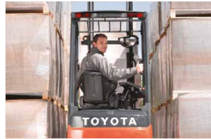
Pega de auxílio traseiro aumenta o conforto na marcha atrás e a produtividade, ao reduzir a tensão nas costas. Banco rotativo como opção, aumenta o conforto, facilitando a saída e entrada do operador.
