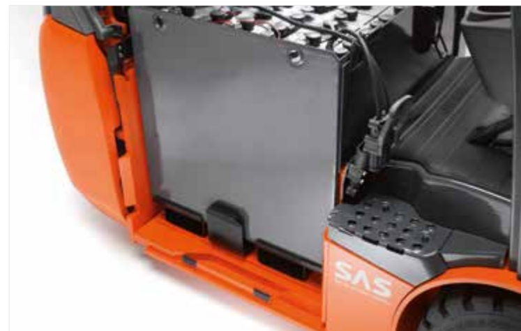
Extração lateral da bateria com encaixe para garfos ou com rodízios incorporados.
