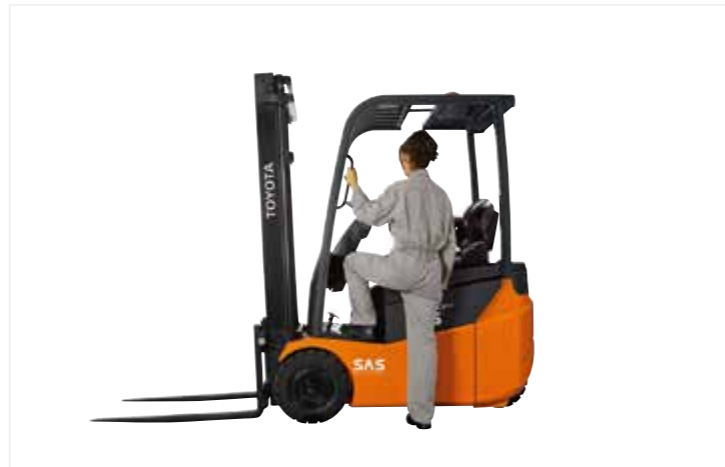
Degrau de entrada baixo torna fácil o acesso ao empilhador para qualquer operador.
