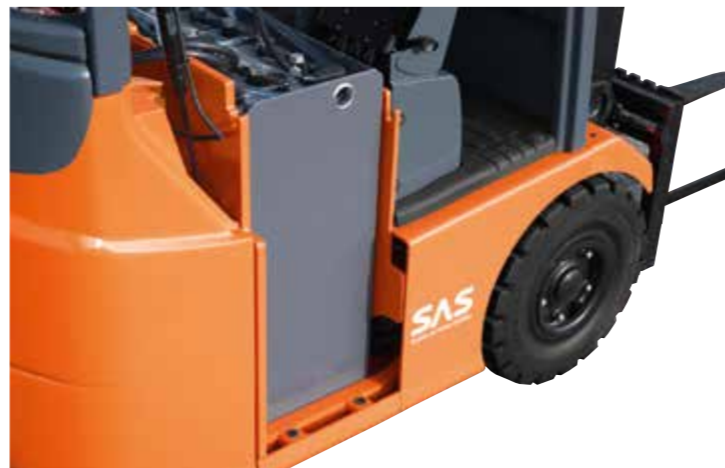
Extração standard da bateria através de uma elevação reduzida da mesma. Tapete com rodízios incorporado, para trocas rápidas, como opcional.
