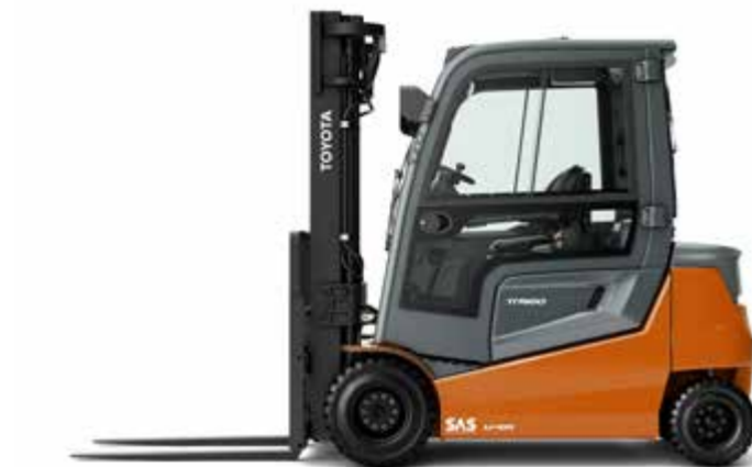
O compartimento do operador totalmente flutuante isola o operador de vibrações e ruídos para maior conforto e produtividade.
