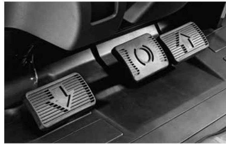
Diferentes layout de pedais para se adequarem a preferência do operador. (na imagem opção de pedal duplo)
