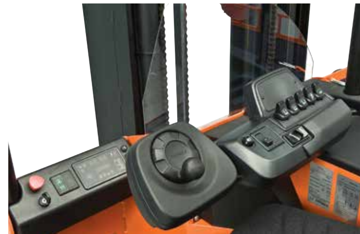
L'operatore guarda nella direzione delle forche, ideale per movimentare carichi lunghi o fuori sagoma
