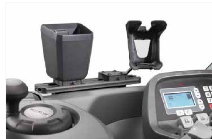
E-bar, disponibile in opzione, per tutti i dispositivi ausiliari
