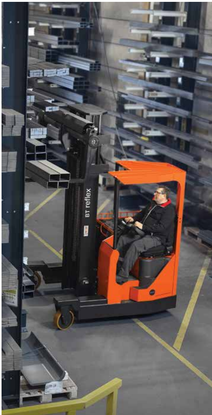
Il posizionatore forche che equipaggia il BT Reflex Serie F, permette di adattare rapidamente il carrello alla movimentazione di carichi di differenti dimensioni
