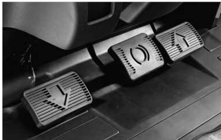
Különbféle pedárelrendezések a gépkezelők igényeinek megfelelően (a képen a duplapedálos változat látható)
