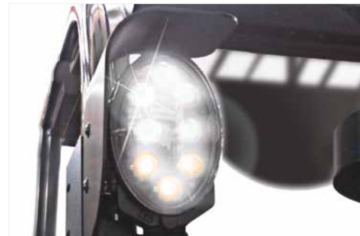
Az erős és hatékonyan működő LED munkalámpák segítségével a gép megvilágítatlan helyeken és éjszaka is bevethető
