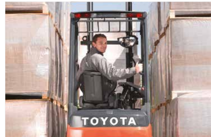
A hátrafordulást segítő kapaszkodó jelentős könnyebbséget jelent a gépkezelőnek, mivel csökkenti a hátizmok terhelését, és ezáltal kényelmesebb testhelyzetet tesz lehetővé hátramenetben, egyúttal javítva a munka termelékenységét is. Az opcionális forgatható ülésnek köszönhetően könnyebb a be- és kiszállás, valamint a tolatás
