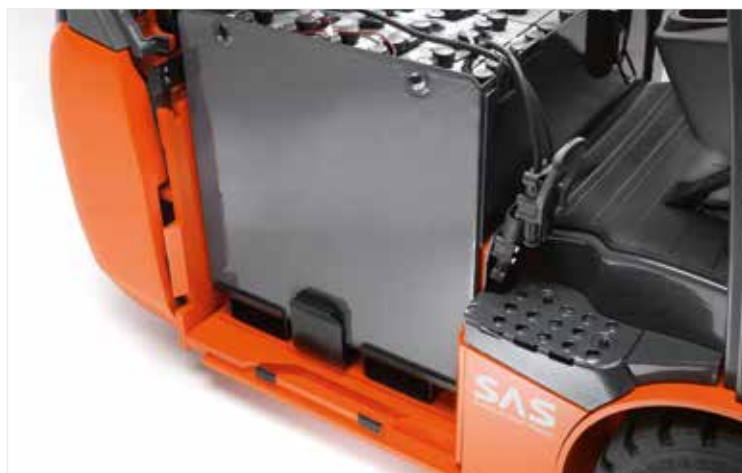
Odalról, papucsos tálcával kiemelhető (lásd a kepeket) vagy beépített görgős ágyon kicsúsztatható akkumulátor
