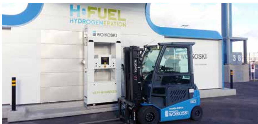
Ravitaillement en hydrogène du chariot frontal Traigo 80 V sur le site de Woikoski, en Finlande.
