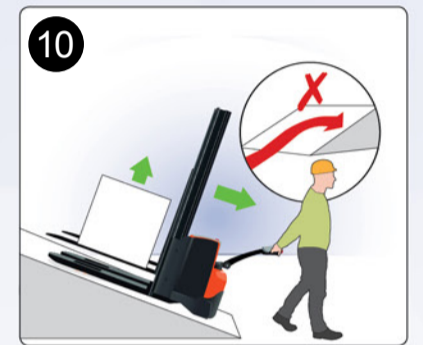
10 Im Gefälle Lasten immer bergseitig führen und auf Rampen nur geradeaus fahren
