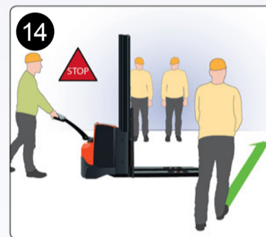
14 Laufwege im Auge behalten, Fahrgeschwindigkeit beachten und immer darauf vorbereitet sein, das Gerät sofort stoppen zu können
