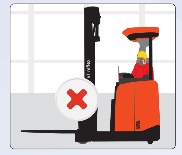
Ne conduisez pas avec un mât déployé. Cela réduit la stabilité et peut causer des dommages inutiles aux produits et au chariot lui-même.
