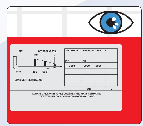
Vérifiez la plaque de charge puis élevez et abaissez les fourches sans charge de façon à vérifier que l'appareil fonctionne correctement.
