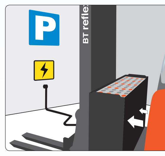
Retirez la batterie si nécessaire et veillez à ce qu'elle soit branchée sur le chargeur.
