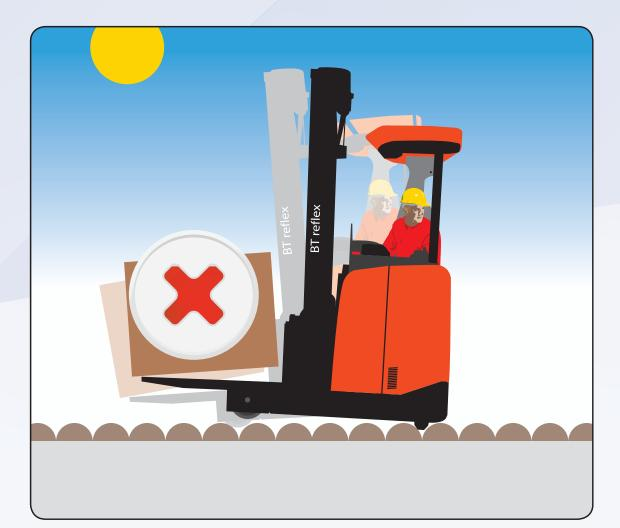
Conduisez un chariot à mât rétractable seulement sur sol plan.
