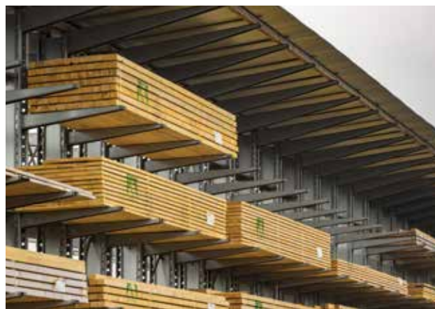
Pour le stockage en extérieur, le Cantilever peut être équipé de toitures et de parois latérales afin de protéger la charge des intempéries.
