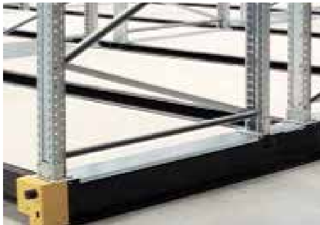
Les barrières de sécurité intérieures permettent d'arrêter le mouvement du palettier lorsque le système détecte l'entrée d'une personne dans l'allée.
