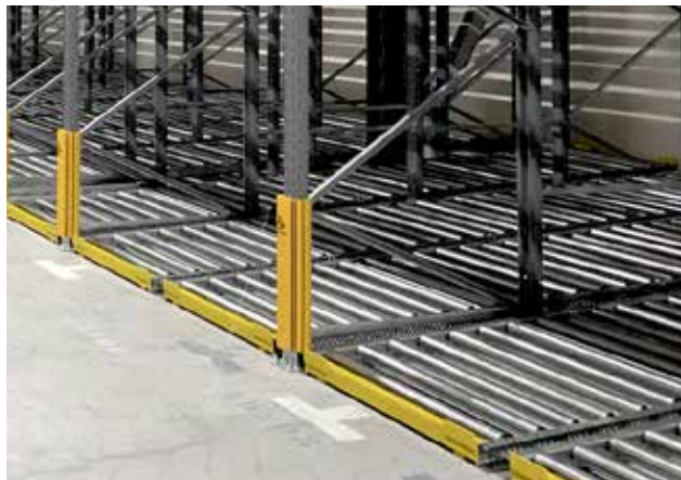
Rouleaux pour un flux de marchandises fluide.
