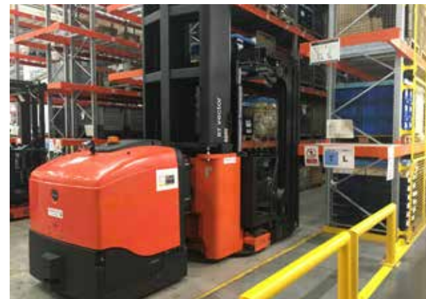
Les chariots à allées très étroites (VNA) prennent et déposent les marchandises dans des zones dédiées en bout d'allée.
