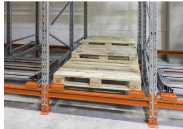
Système PUSH-BACK avec cadres.
