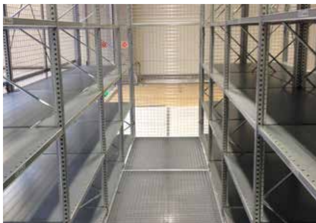
Sécurité accrue grâce au grillage antichute et à la possibilité de fermeture de certaines zones.
