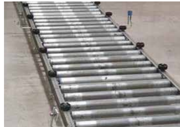
Dispositif de guidage latéral pour un meilleur contrôle de la palette en mouvement.
