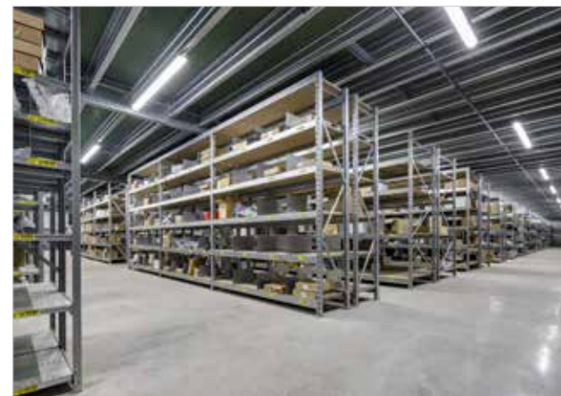
Le système de rayonnage à étagères grande largeur constitue une solution robuste et flexible pour la manutention de charges lourdes.
