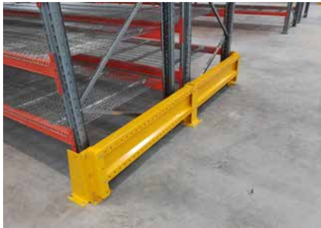
Les protections d'échelles empêchent les dommages aux rayonnages.
