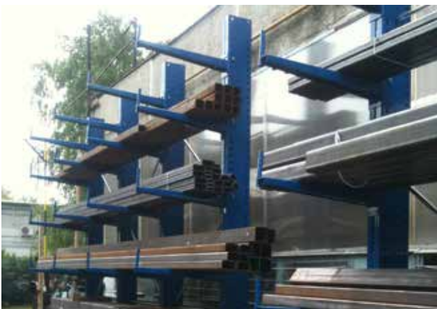
La structure du Cantilever permet le stockage de matériaux en vrac ou de produits de tailles différentes.
